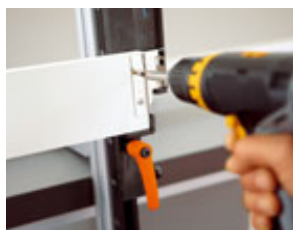
Nejdříve sešroubujte dřevěnou zadní stěnu a držáky zad.
