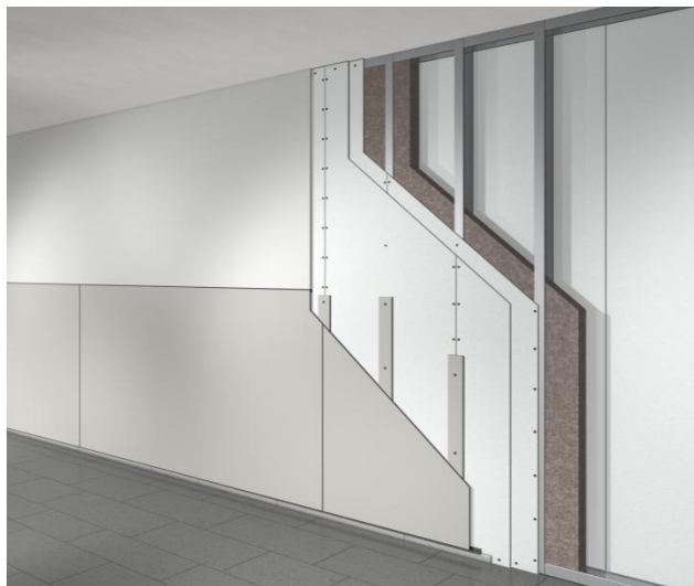
Obrázek 33 – obložení stěn do poloviční výšky – stěna v suché výstavbě (nosná konstrukce)
