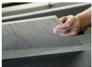
Obr. 12 – desku s kam. dýhou položit kamenem na gumu a zalisovat
