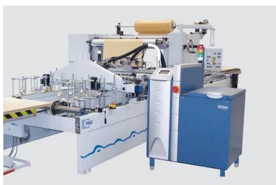
Obrázek 3 Označení stroje: PROFI FKP 150/1/13/DH/R Použití: Kaširování dveří s CPL včetně obalovací zóny
