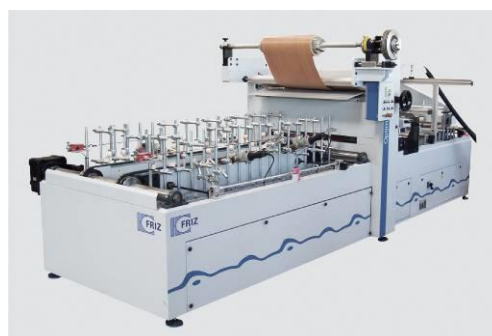
Obrázek 4 Označení stroje: OPTIMAT FKP 100/1/10/DH/R Použití: Kaširování dveří s CPL včetně prodloužené obalovací zóny
